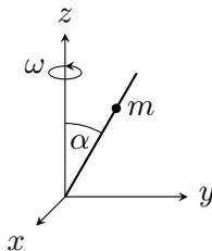
An einer Achse, die sich mit der Winkelgeschwindigkeit  $\omega$  dreht, ist unter dem Winkel  $\alpha$  ein gerader Draht befestigt, auf dem eine Masse  $m$  reibungsfrei gleitet (der Draht dreht sich laut Skizze, in dieser Aufgabe keine Schwerkraft!).
