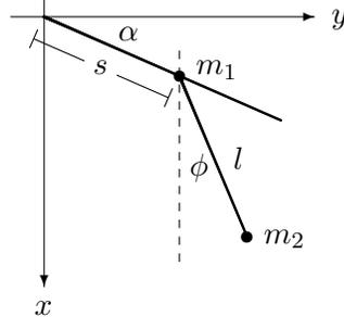
Ein Teilchen der Masse  $m_1$  gleite reibungsfrei unter dem Einfluss der Schwerkraft entlang einer Geraden, die den Winkel  $\alpha$  mit der Horizontalen bildet. An dem Teilchen sei die Masse  $m_2$  mittels eines gewichtslosen Fadens der Länge  $l$  befestigt.
